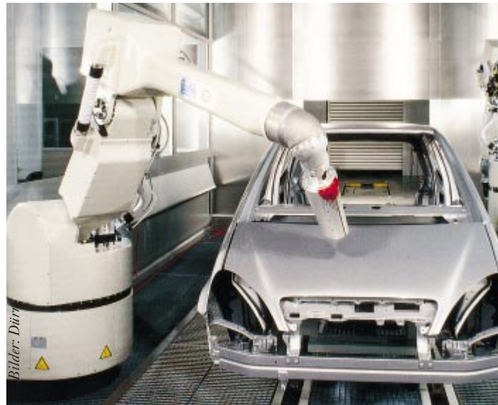
Je nach Anwendungsfall kann die Lackierung von Karosserie-Außenteilen mit Dachmaschinen oder mit Robotern erfolgen
