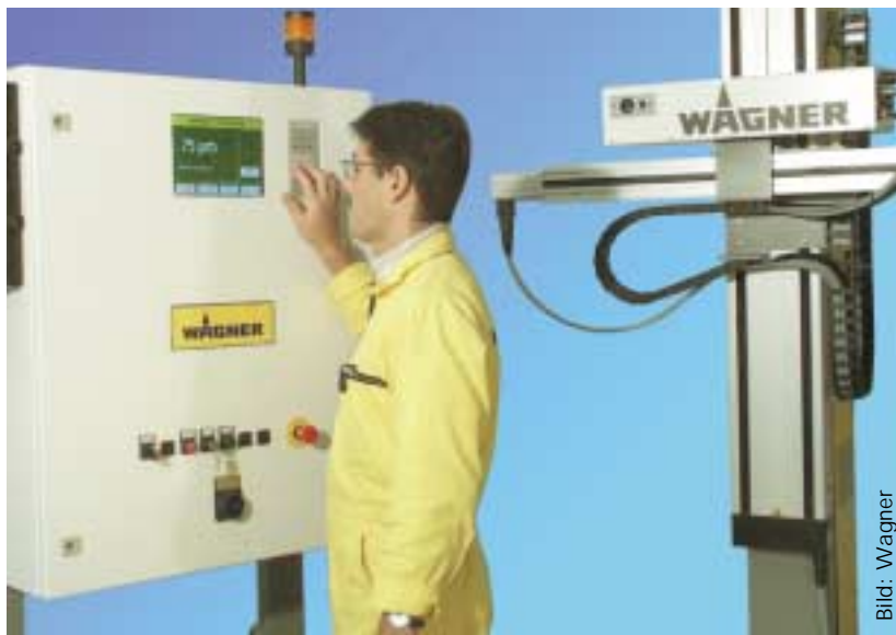
Ein Messgerät der zweiten Generation, mit elektrischer Kühlung und optimierten Linearachsen, stellte Wagner vor wenigen Monaten erstmals vor
