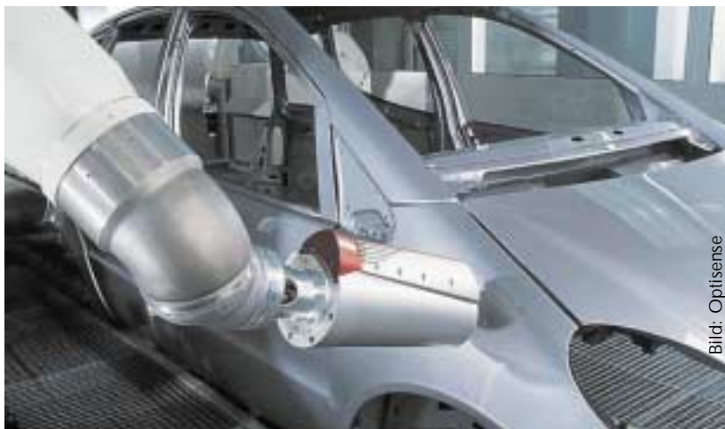
Anwendungsbeispiel für das Online-Schichtdickenmesssystem von Optisense: Bei einem Automobilhersteller erfolgt die Messung durch einen Messkopf, der auf einem 6-Achsenroboter direkt nach der Lackierung positioniert ist.
