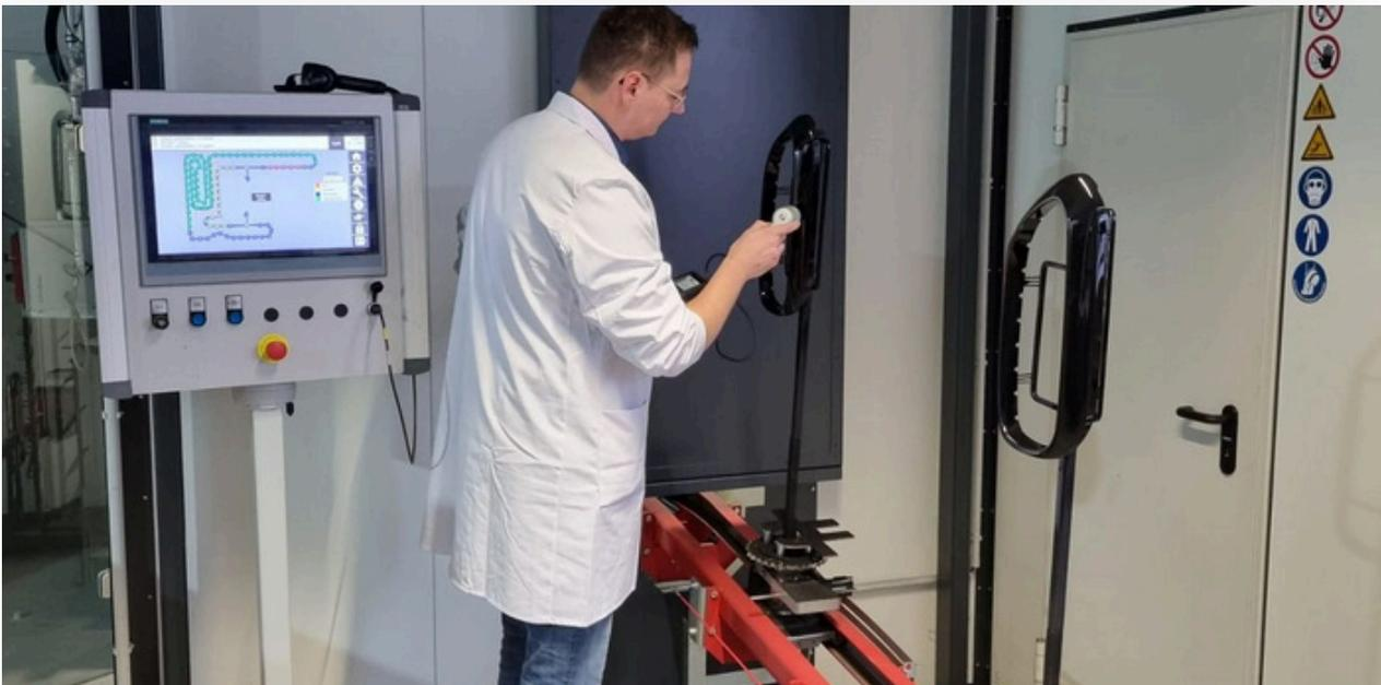
Mit dem PaintChecker wird die Gleichmäßigkeit des Auftrags im noch nassen Zustand geprüft
